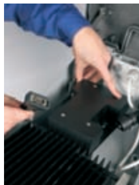
Odšraubovanie matice zaistenia adaptéru a odpojenie napájacieho káblu bez použitia náradia.
