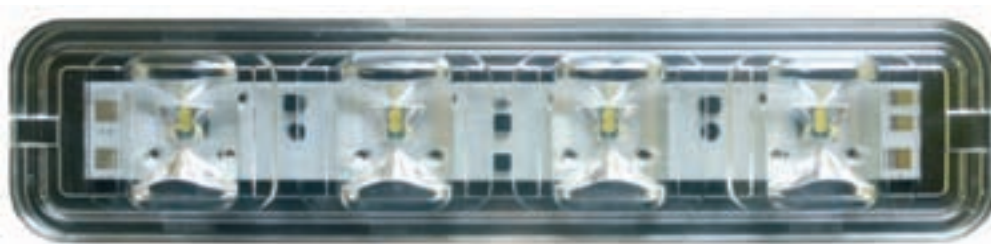
Konstrukce optického modulu používaného v produktech ROSA LED
