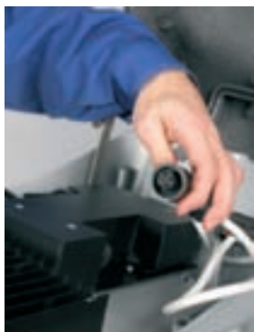
Odšraubovanie matice zaistenia adaptéru a odpojenie napájacieho káblu bez použitia náradia.
